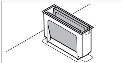
3. Drücken Sie die beiden Elemente vorsichtig von außen nach innen und falten Sie sie zusammen. Nehmen Sie dann den Filter aus dem Filtergehäuse heraus.
